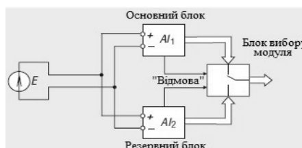
Рис. 2 Дублювання модуля введення методом заміщення
