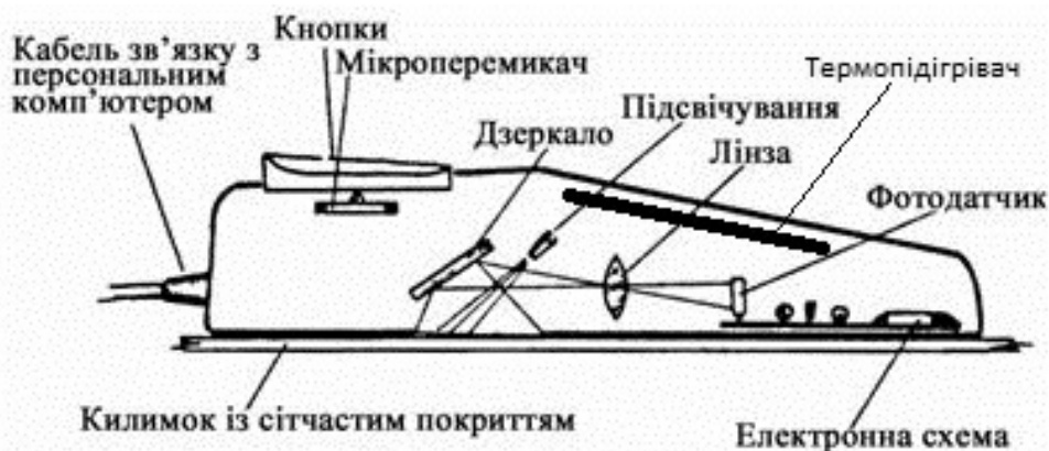
Рис. 1. Структура маніпулятора типу миша з термопідігрівом.
