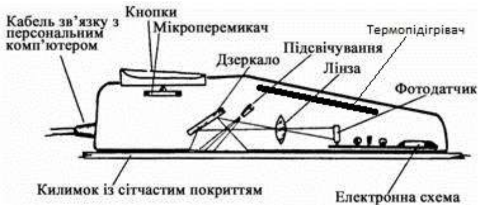
Рис. 1. Структура маніпулятора типу миша з термopідгpівачем.
