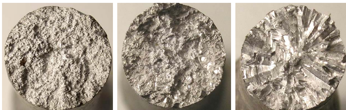
Рисунок 1 – Макроструктура изломов образцов, \times 5 : a - 99,9 % Mg, б - МЛ5, в - МЛ5 + 0,1 % Zr
