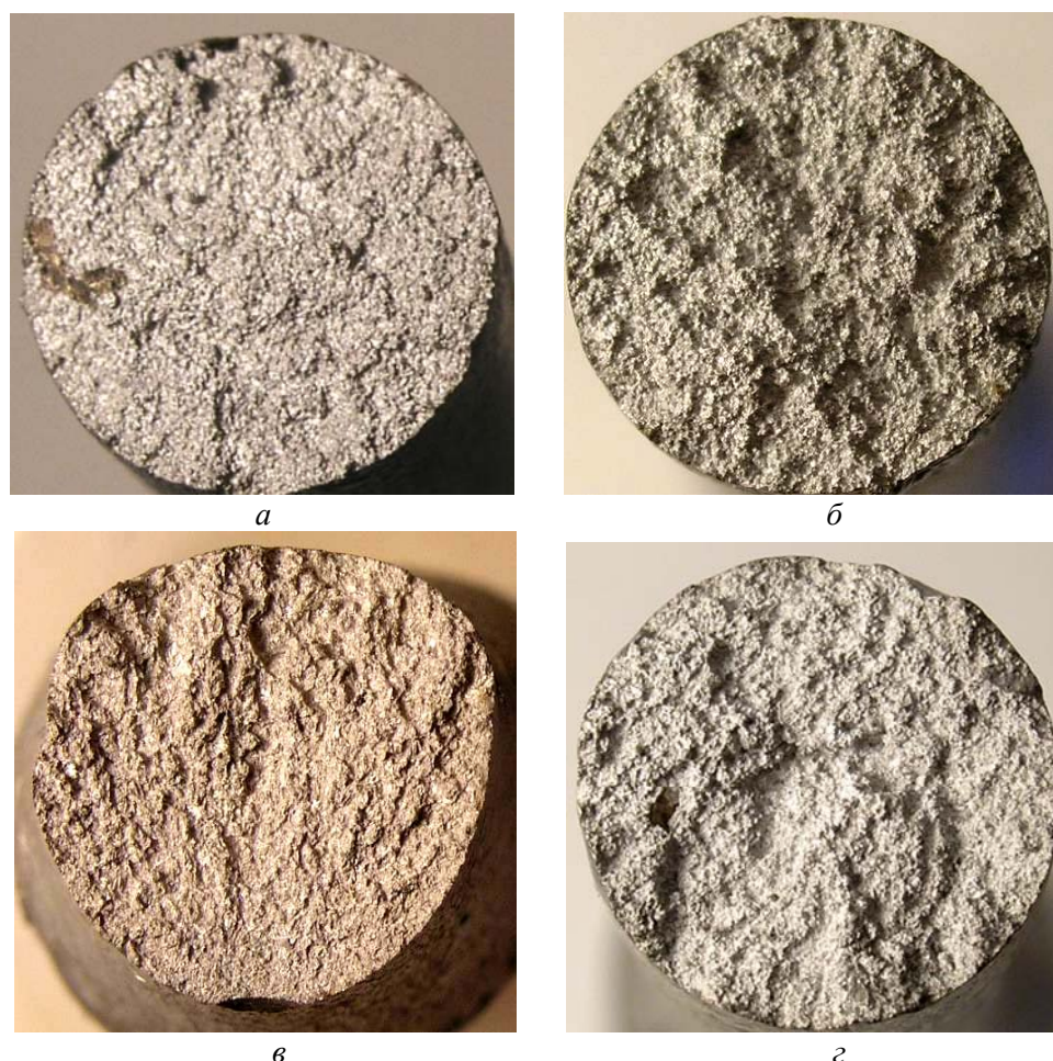
Рисунок 1 – Макрофрактограммы изломов образцов из сплава МЛ5, \times 5 : а - стандартный сплав; б - 0,1 % Ti; в - 0,1 % Zr; г - 0,1 % Hf
