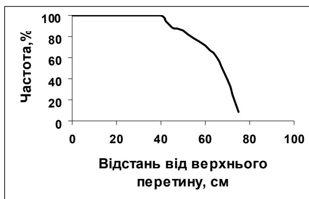
Рисунок 1 – Частотний аналіз розподілу перетинів монокристалів кремнію, де \tau_{\text{HHЗ}} \geq 10 мкс, за їх довжиною
