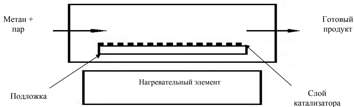
Рисунок 4 – Схема установки для получения углеродных нанотрубок разложением углеводородов в присутствии катализатора
