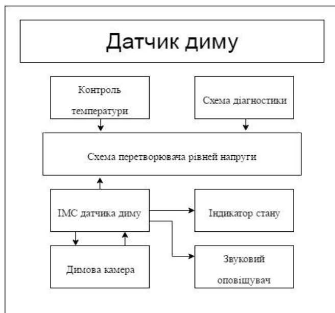
Рисунок 1.1- Загальна блок схема датчику диму
