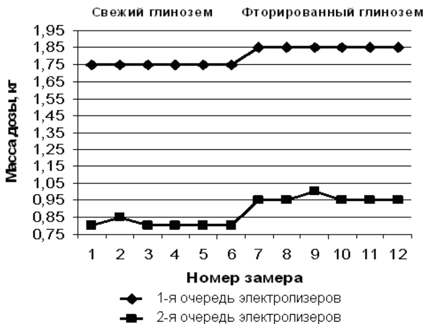
замеры 1...6 относятся к порциям свежего глинозема, замеры 7...12 – к порциям фторированного глинозема
