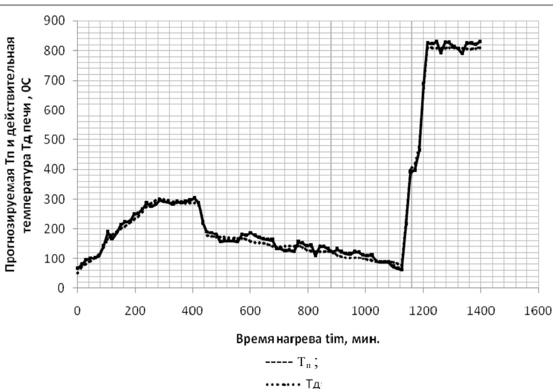
**Рисунок 1** – Изменения во времени действительной  $T_\Delta$  и прогнозируемой  $T_n$  температуры свода камерной нагревательной печи
