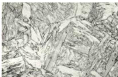
**Рисунок 1** – Структура цементованного слоя стали 12ХН3А
