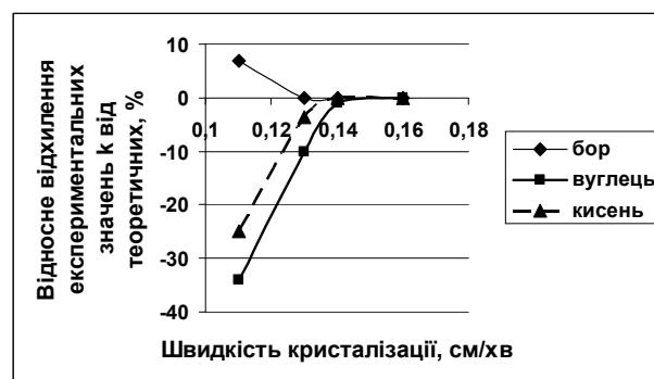
Рисунок 3 – Відносне відхилення \delta k експериментальних значень k_{екс} від розрахованих за рівнянням (1) k_{теор} для основних домішок у кремнії
