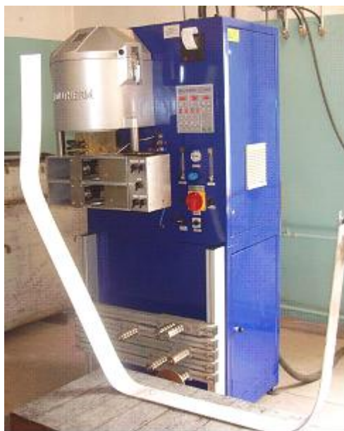
Рисунок 1 – Установка вертикального непрерывного литья СС 3000 (на переднем плане готовая продукция - полоса из серебра 99,99 %)
