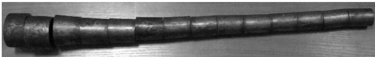
Рисунок 1 – Досліджувана заготовка труби, що прокатана на стані ХПТ-55 за маршрутом 57 \times 7,5 \Rightarrow 31 \times 3,5
