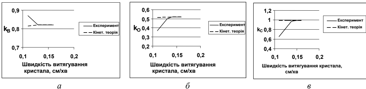
Рисунок 2 – Залежність величини ефективного коефіцієнта розподілу основних домішок у монокристалі кремнію від швидкості витягування монокристала
