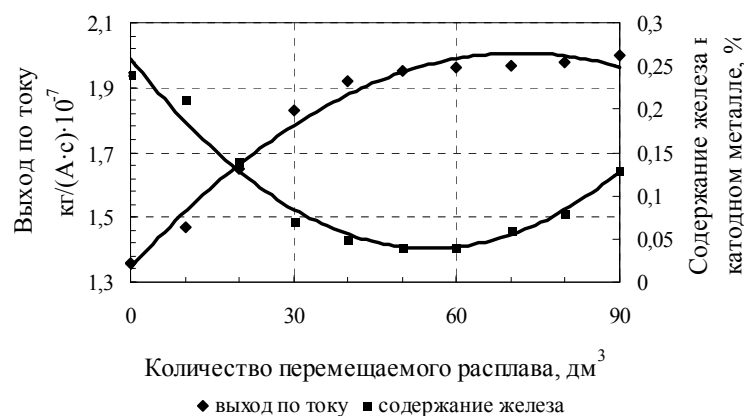
Рисунок 4 – Показатели процесса электролитического рафинирования с периодическим перемещением расплава
