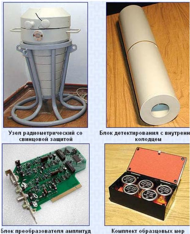
**Рисунок 2** – Основные узлы радиометра удельной активности стальных проб «РУГ-2001»
