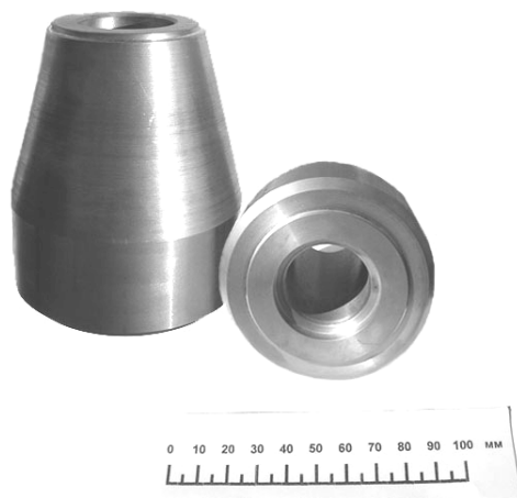
Рисунок 3 – Бочки валков из стали P6M5, изготовленные из отливки ЭШВ
