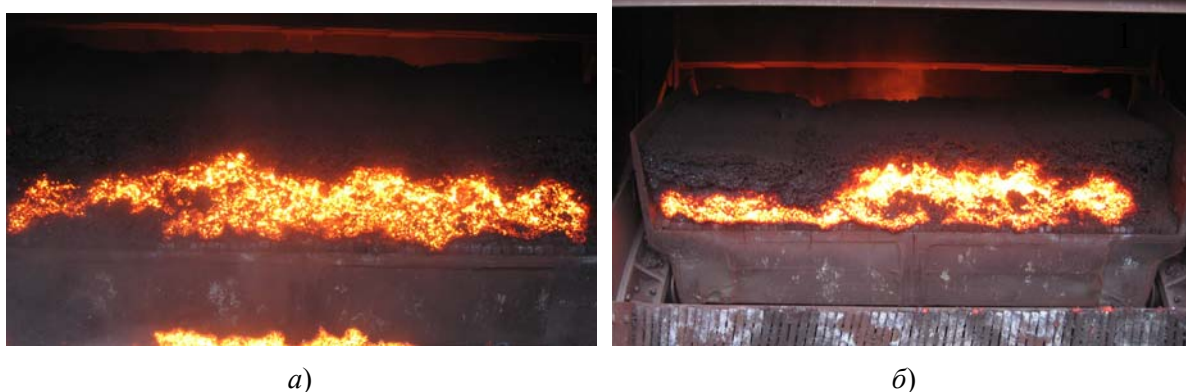
а - одноступенчатый лоток; б - двухступенчатый лоток со стреловидной формой второй ступени
