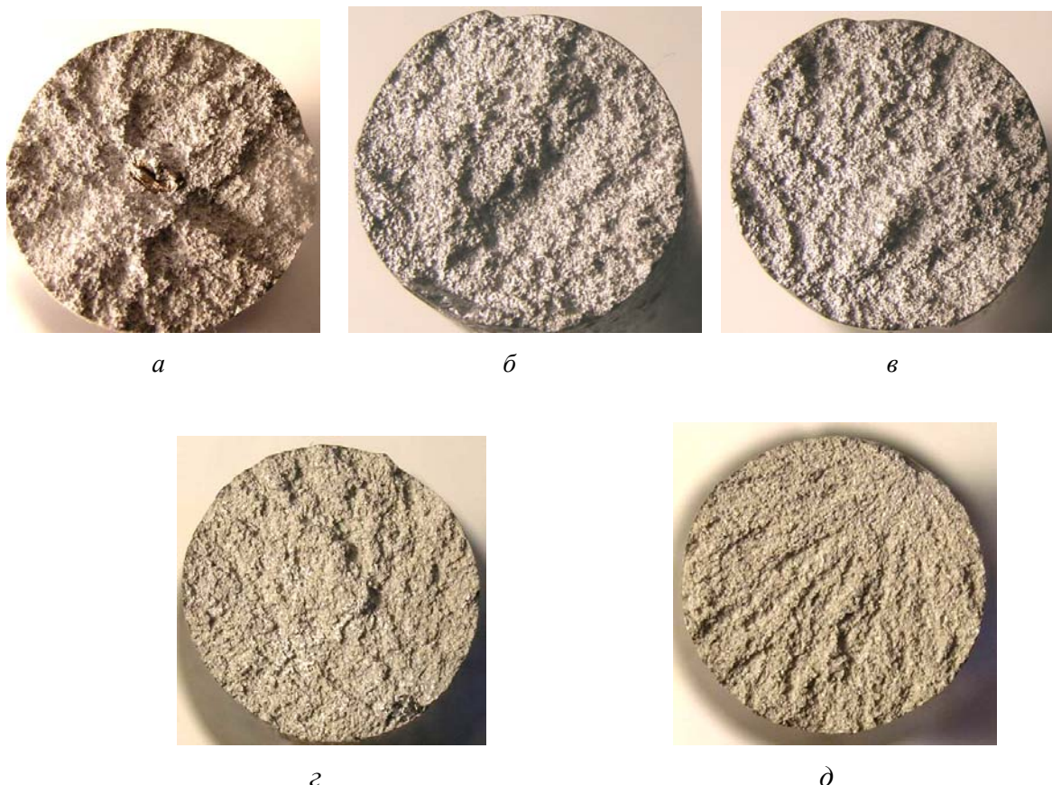
a - исходный сплав; б - 0,05% Sn; в - 0,1% Sn; г - 0,05% Pb; д - 0,1% Pb
