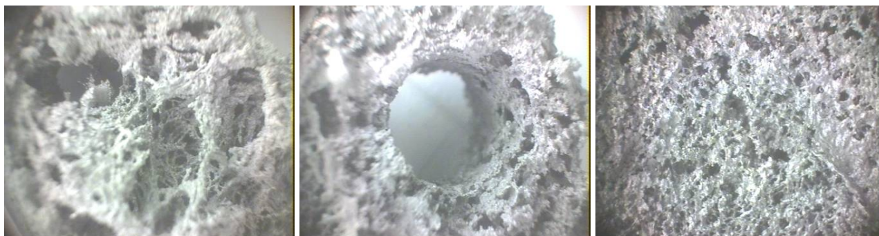
Рисунок 4 – Структура титановой губки, полученной на экспериментальной установке
