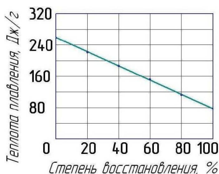
Рисунок 4 – Зависимость теплоты плавления неметаллической составляющей от степени восстановления агломерата
