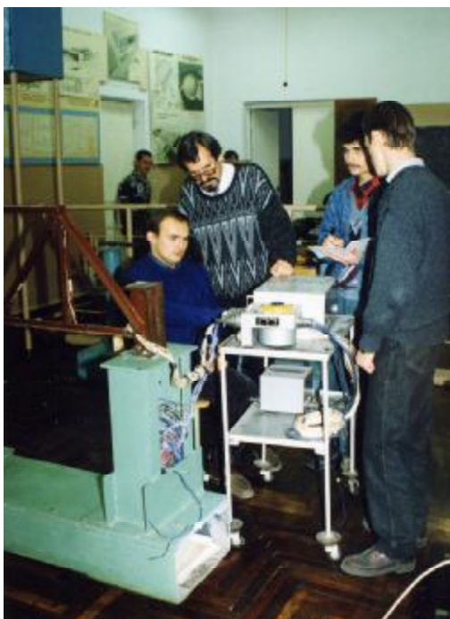
Студенти-будівельники досліджують напружено-деформований стан мостової ферми. Науковий керівник доцент О. П. Радченко
