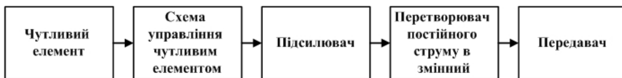
Рисунок 1 - Структура бездротового датчика тиску
