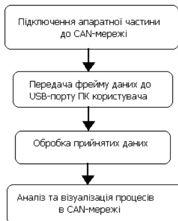
Рисунок 1 – Загальний алгоритм функціонування програмно-апаратного комплексу
